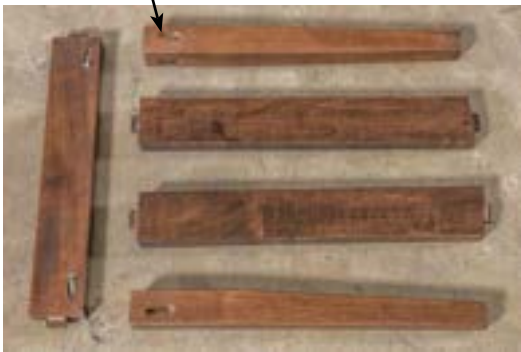
mortis & tenon construction
